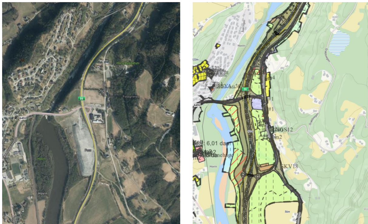
Figur 6 - I området ved avkjøring til Hovin er det i gjeldende plan regulert et toplanskryss. I optimaliseringen vil en forbedret trafikal løsning vurderes, samtidig som det er et mål at kryssutforming skal gi redusert massebehov samt mindre beslag av permanent og midlertidig jordbruksareal.
