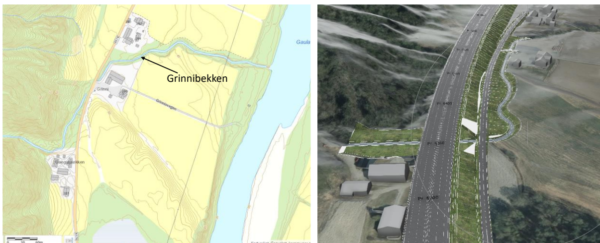
Figur 3-7: Grinnibekken i dagens situasjon (venstre) og med planlagt linje i alternativ 1.1./1.2A (høyre) (Kilde: Norconsult).
