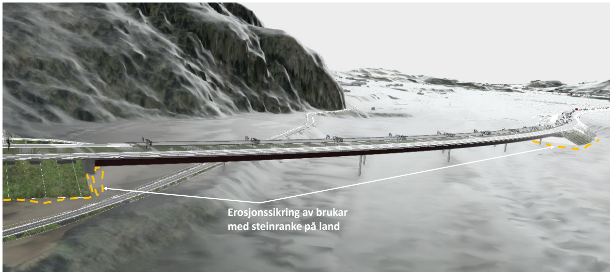
Figur 6-3: Bru Ler fra 2D-modell, erosjonssikring ved brukar (Kilde: Norconsult).
