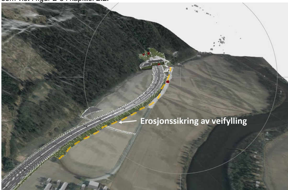
Figur 3-8: Fylling på flomsletta sør for Homyrkamtunnel (Kilde: Norconsult).
