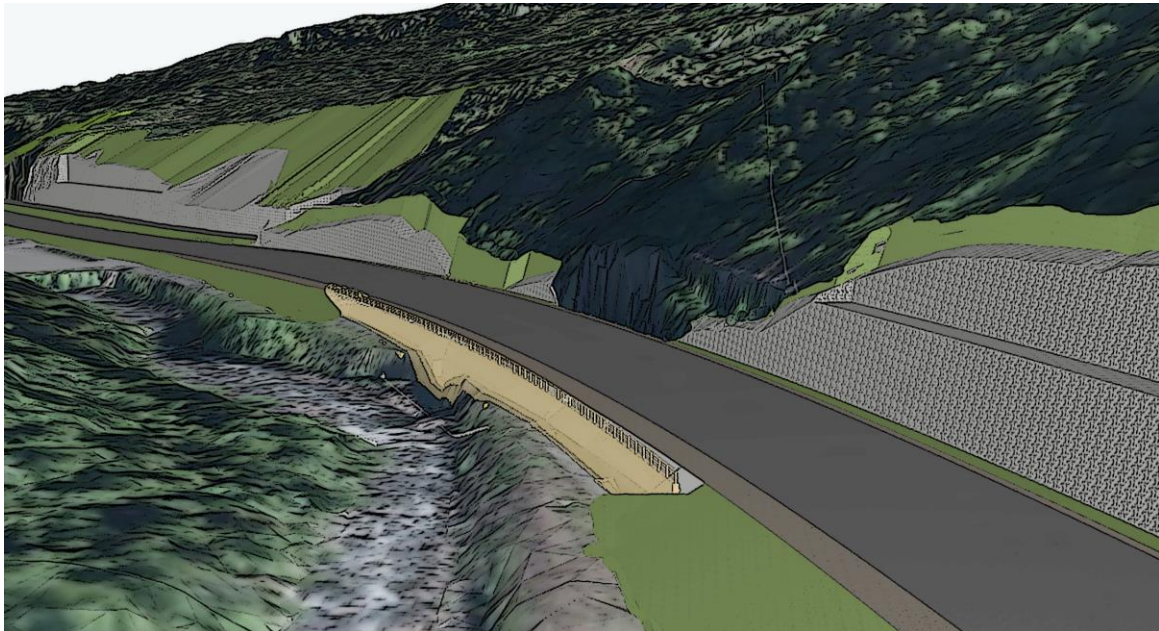
Figur 12 Illustrasjon av støttemuren i landskapet
