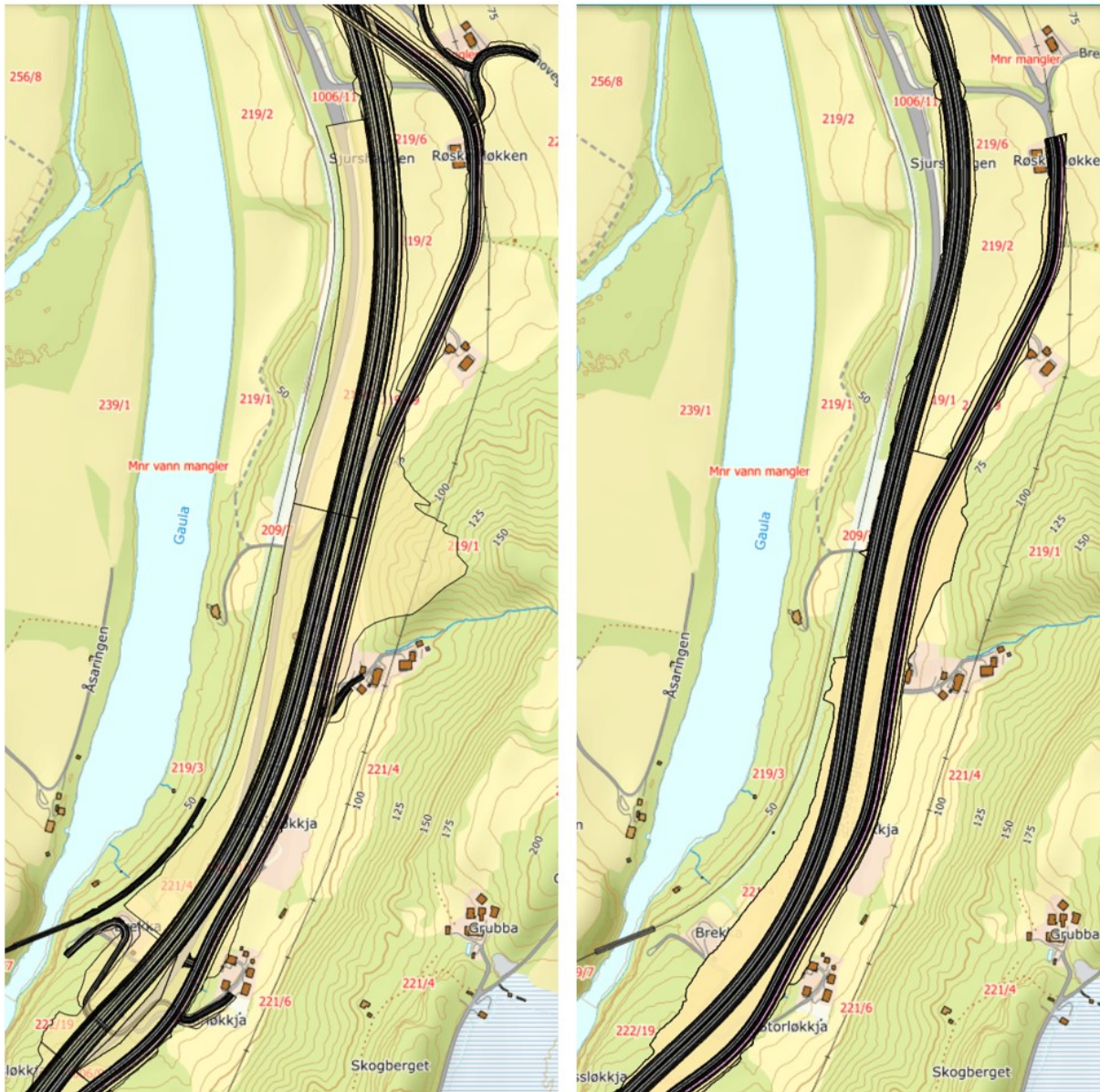
Figur 3-3 Veilinje mellom Horg bygdetun og Røskaft med 110 km/t (alt.1.1) til venstre og 100 km/t (alt.1.1C) til høyre. Reduserte krav til vertikalkurvatur i 1.1C gjør at veilinja i større grad følger dagens E6 og skjæring i åsryggen og fylling mot jernbanen reduseres. Gang- og sykkelveiløsning i sør, adkomstveier og lokalveier er ikke detaljert ut i illustrasjonen til høyre. Kilde: Norconsult.
