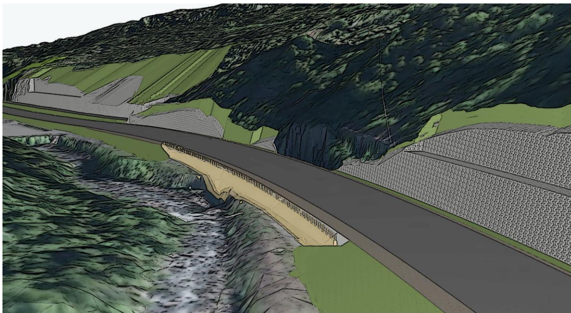
Figur 50 Illustrasjonen viser vegføring, fylling, skjæring og muring langs Ila ved profil 34.920 og nordover
