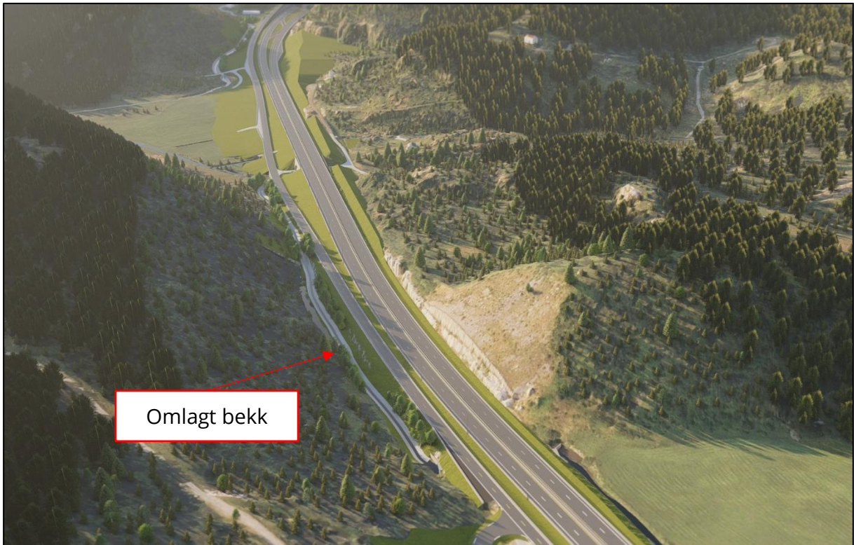
Figur 3-29 Bekkeomlegging fra Ytre Tjomslandsvann mot Steggjevannet (nedre del)
