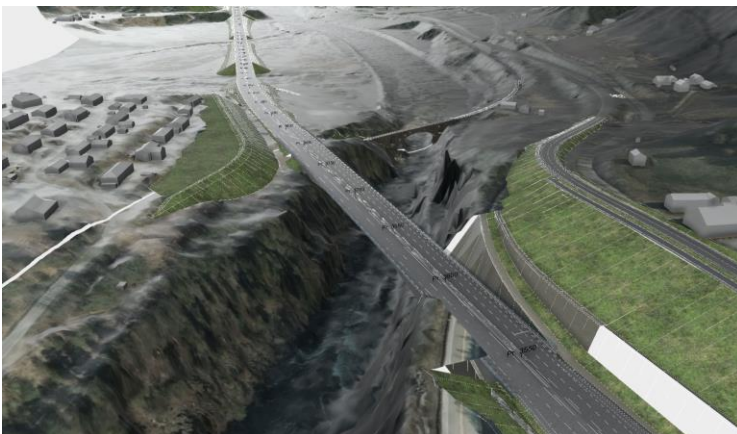
Figur 5-14: Utklipp fra modell som viser Hovinbrua og terrengforming langs Hovinåsen. Hvordan brua treffer sideterrenget må jobbes videre med i neste fase. Kilde: Norconsult.
