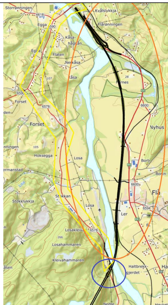
Figur 5-36: Anleggsområder vest og øst for Gaula i alternativ 2.2. Områder i øst og nord (oransje omriss) avhenger av massetransport på offentlig vei
