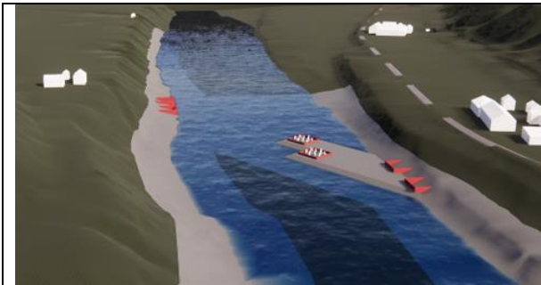
Figur 5-44 temporær fylling med spuntkasser og peler. (Bildet viser prinsipp, viser ikke det aktuelle brustedet)
