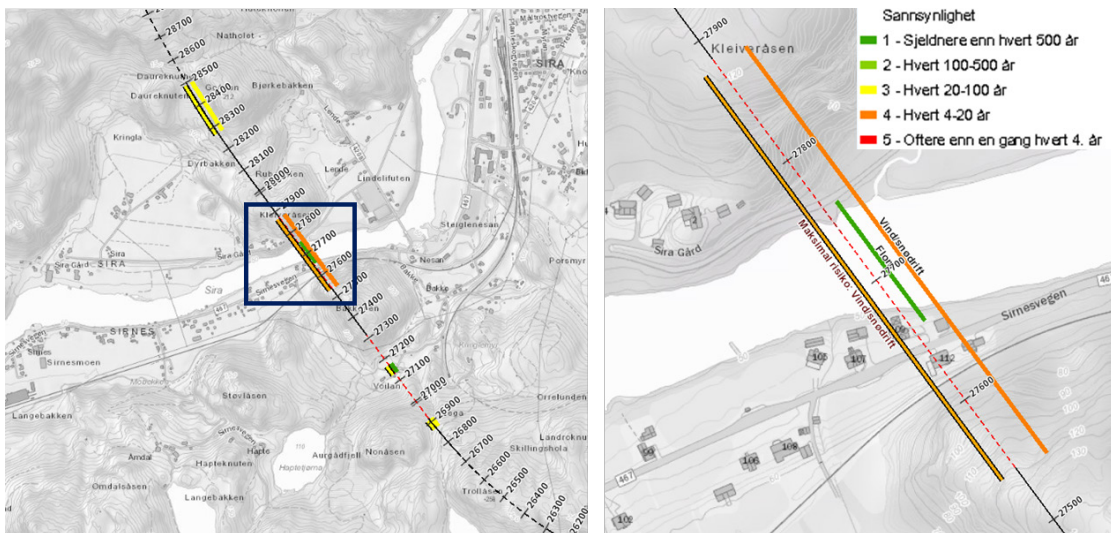
Figur 6.1 Utdrag fra kartleveransen, E39 krysning av Sira. Høyre del viser utsnittet markert med firkant i venstre del, slik det fremkommer når en zoomer inn. Metreringen er her hver 100m. Sannsynligheter for flom og vind/snødrift på høyre side av traséen, som her er markert med bru, og maksimal risiko litt offset, til venstre for traséen. Her er vind styrende for maksimal risiko, som er middels, 2. Faktaark for flomfaren er vist i Figur 6.2
