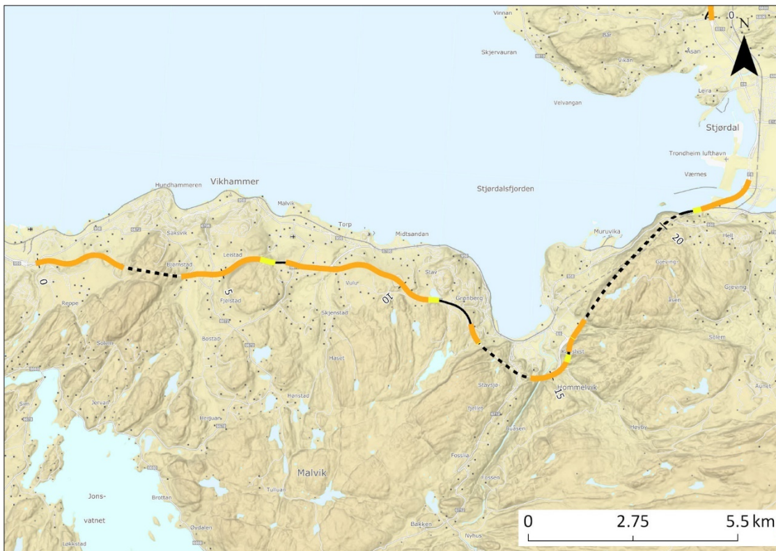
Figur 6.9 E6 Ranheim - Værnes. Fargene viser maksimal risiko i segmenter langs traseen med lav (gul), middels (oransje) og høy (rød). Metreringen (her i km) er generert av NGI og er ikke Nye Veier AS sin 'offisielle' metrering. Detaljer om faretype, konsekvenser, etc. finnes i fakta-arkene i den digitale leveransen.
