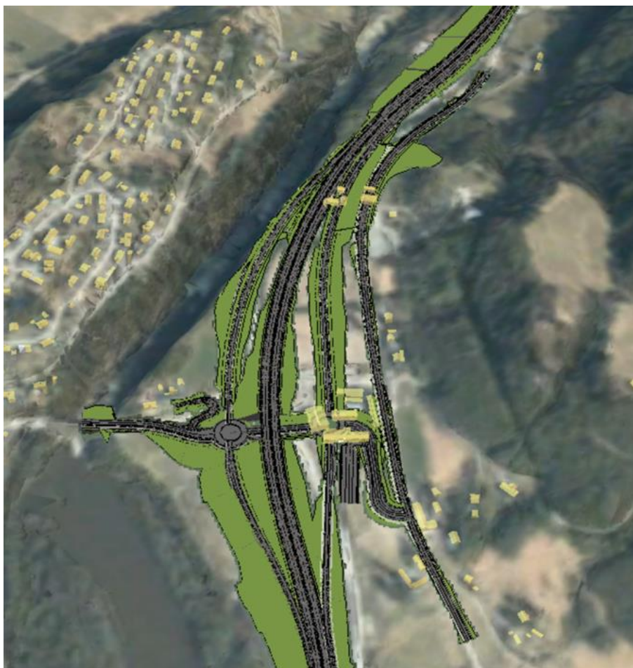
Figur 8-2 Skisse viser et standard ruterkruss ved Hovin for alt. 1.1. (Kilde: Norconsult)
