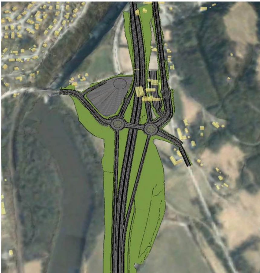
Figur 8-4 Skissen viser et standard ruterkryst ved Hovin for alt. 1.2. (Kilde: Norconsult)
