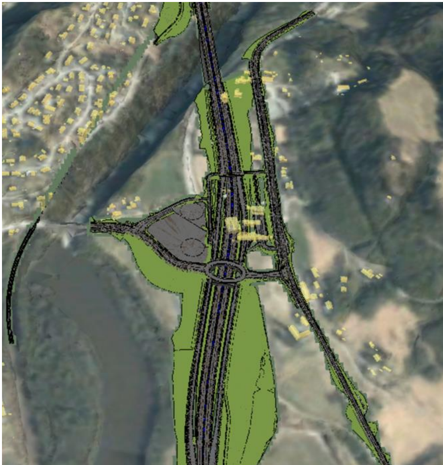
Figur 8-3 Skissen viser en oval rundkjøring over E6 ved Hovin for alt.1.2. (Kilde: Norconsult)
