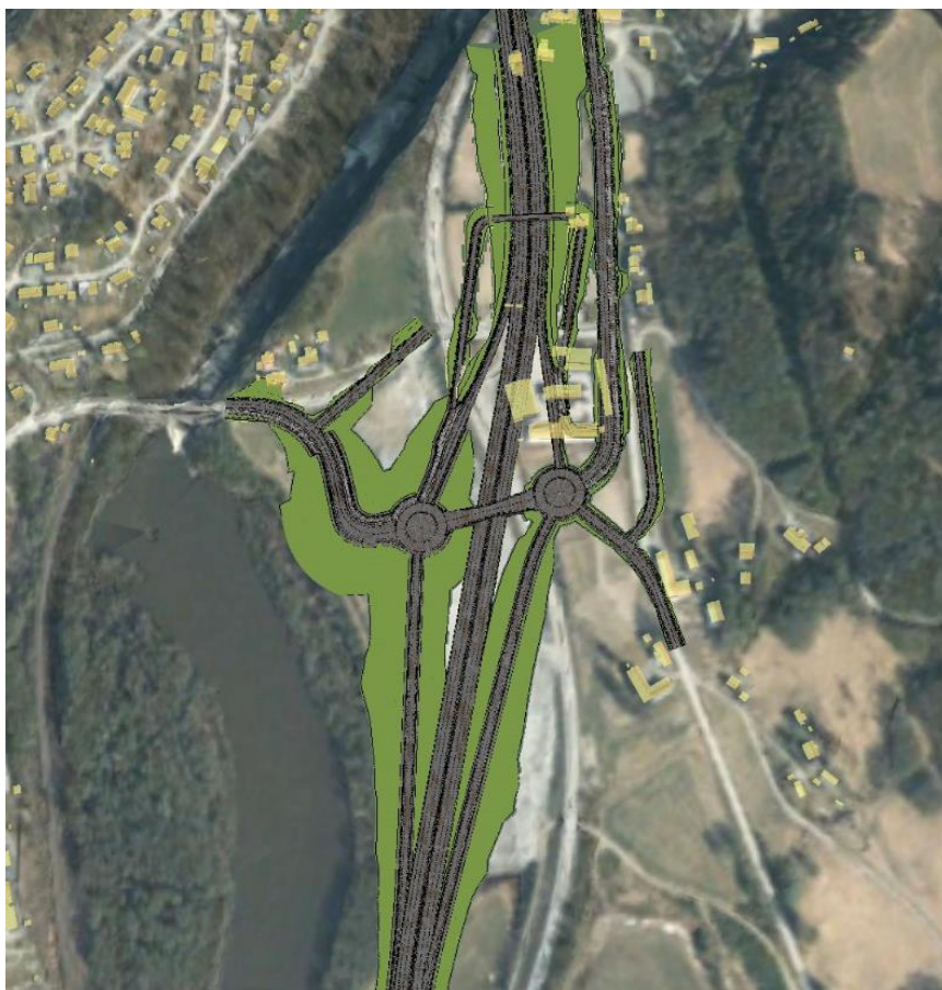
Figur 8-5 Skissen viser et skjevt ruterkruss ved Hovin for alt. 1.2. (Kilde: Norconsult)
