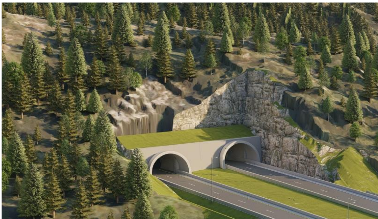
Figur 2-16: Løsning for resterende portaler langs E39
