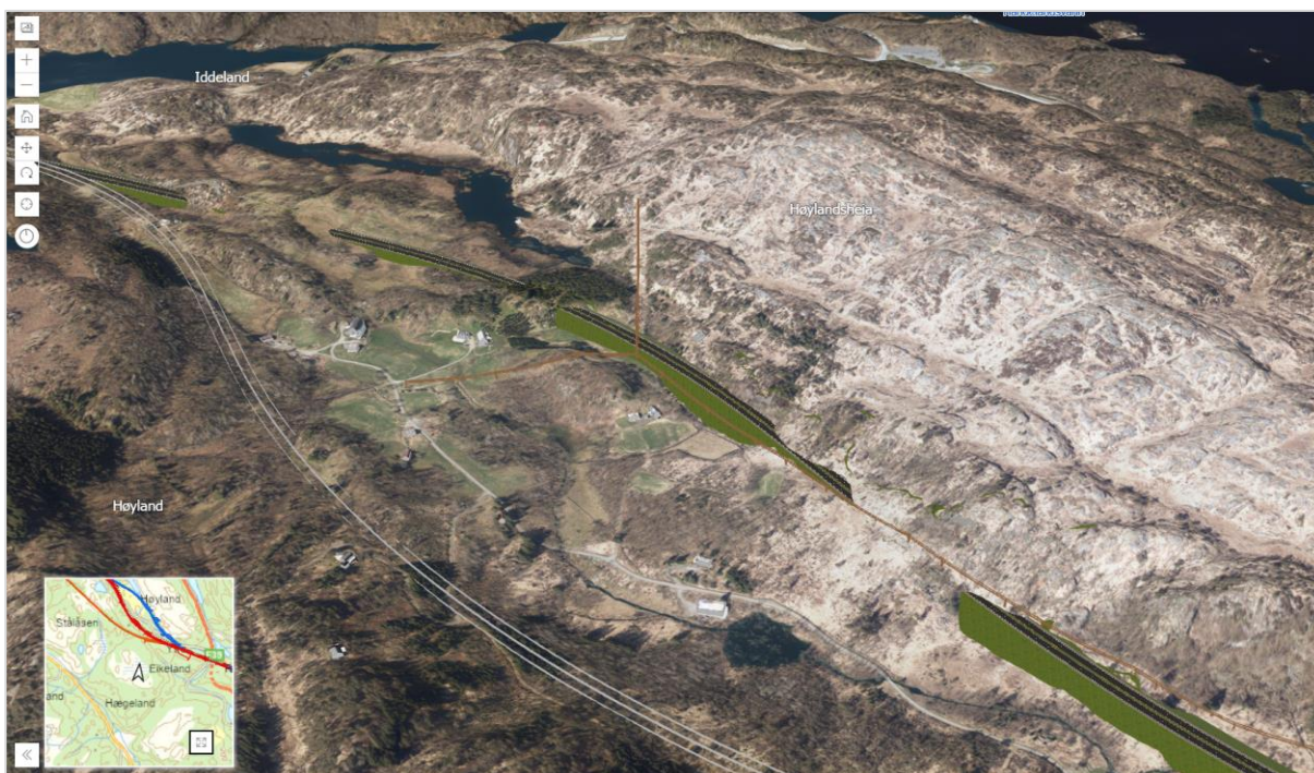
Figur 15: Utklipp fra veimodell i 3D-innsynsløsning viser HDØ i terrenget fra ca. P1450 – 3300.
