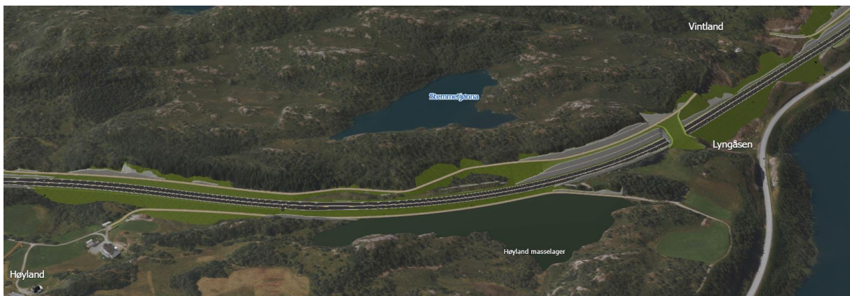
Figur 11: Utklipp av 3D-innsynsløsning som viser plassering av Høyland masselager og Lyngåsen faunapassasje der østsiden vil stå på berg, og vestsiden på tverrskrånende løsmasseterreng. Synsvinkel mot sørvest.
