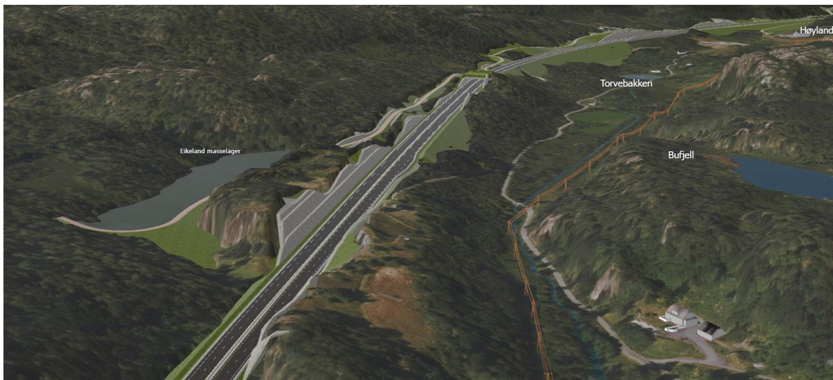
Figur 7: Utklipp fra 3D-innsynsløsning viser omfang av masselager Ytre Eikeland for veilinjens alternativ HDV. Synsvinkel mot vest.
