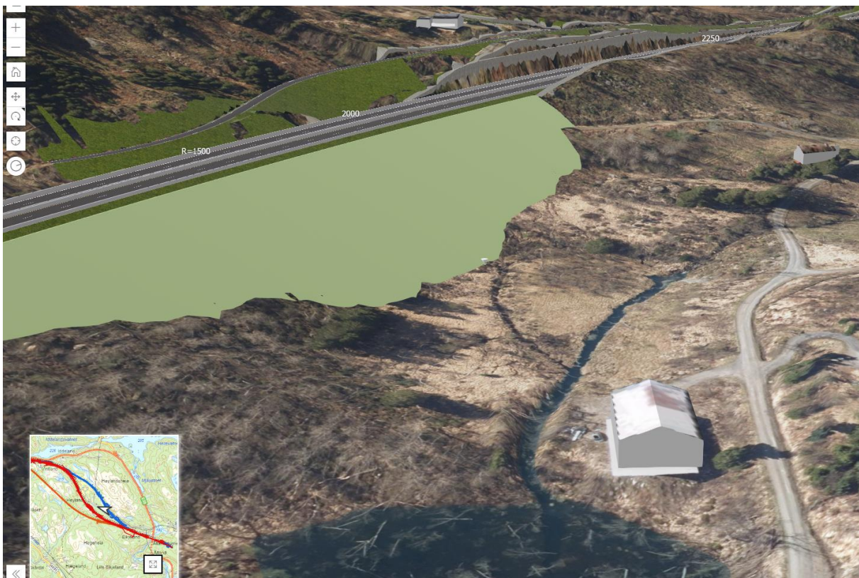
Figur 8: Utklipp fra 3D-innsynsløsning viser fyllingsutslag (1:2) ned mot Steggemyra. Synsvinkel er mot vest.
