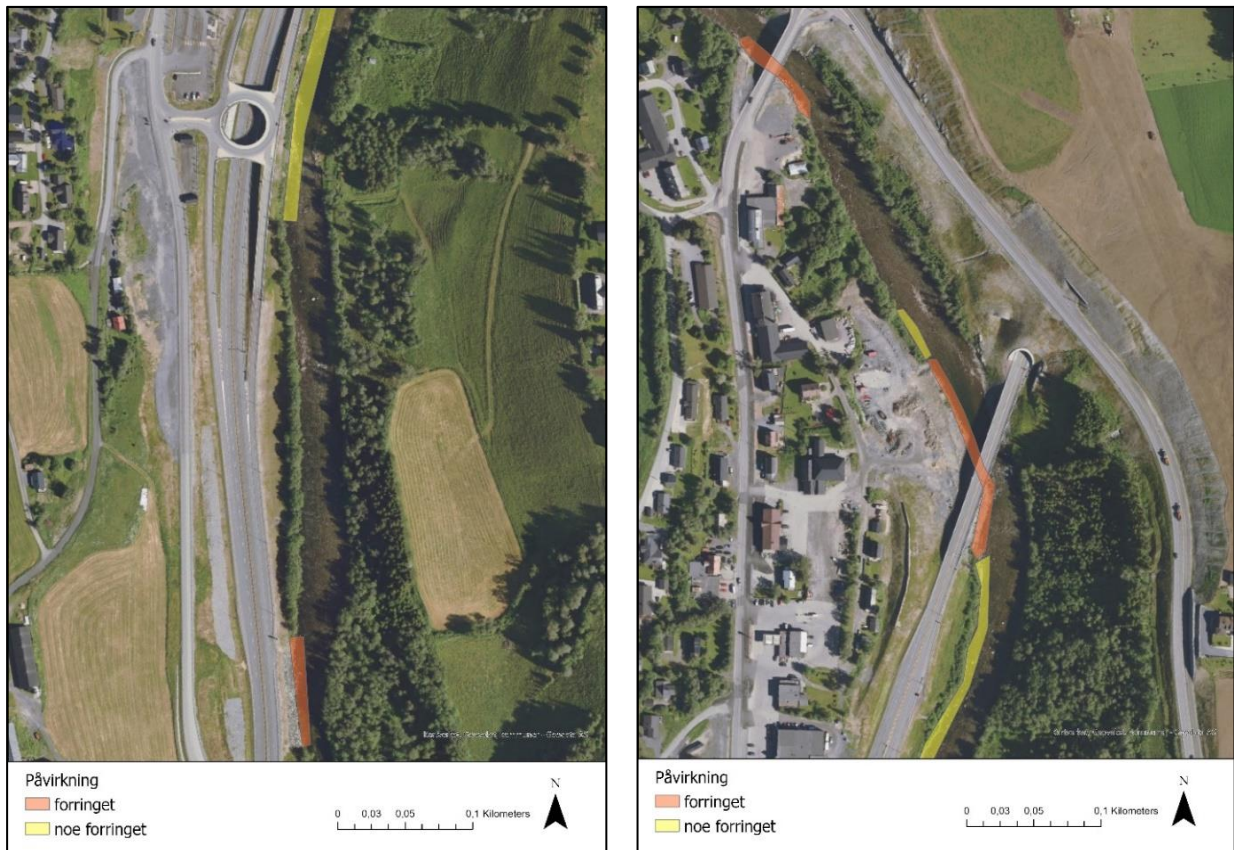
Figur 4-13. Elvestrekninger i Sokna mellom Fossum og Soknedal der ny E6 har påvirket habitatkvalitetene på oppvekstområder for laks og sjørøret.
