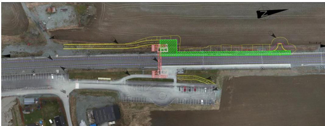
Figur 36; Oversiktstegning over tiltaket. Blått indikerer eksisterende spor, gult indikerer vegtiltak og fylling fra plattform, grønn skravur indikerer ny plattform, brunt/rødt/grått forskjellige komponenter for ny overgangsbru, lilla er nytt gjerde.
