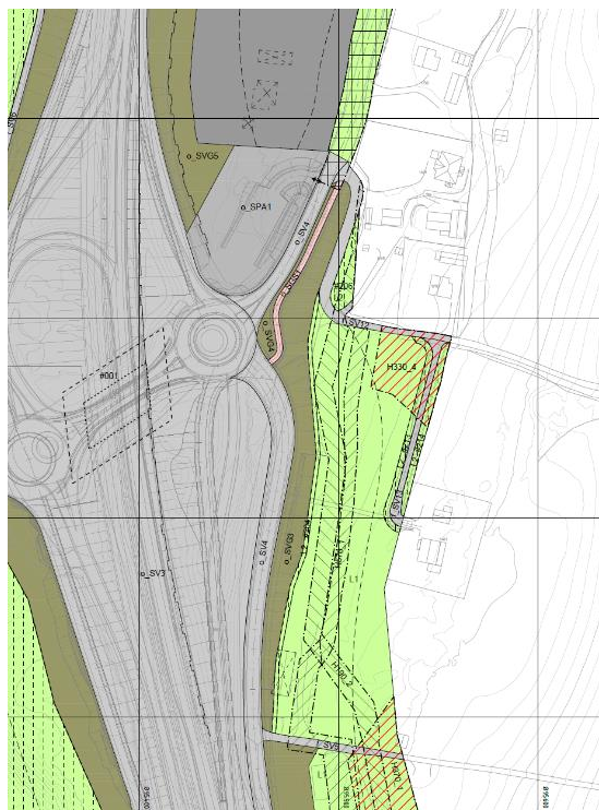
Figur 6-13 Utsnitt fra reguleringsplanen som viser løsning. Fv. 2522 føres inn som egen arm i rundkjøringen, og adkomst til eiendommer løses ved gjenbruk av nordre del av Hundervegen og direkte adkomst rett ut i fylkesveien fra eiendommene ved Ensby.
