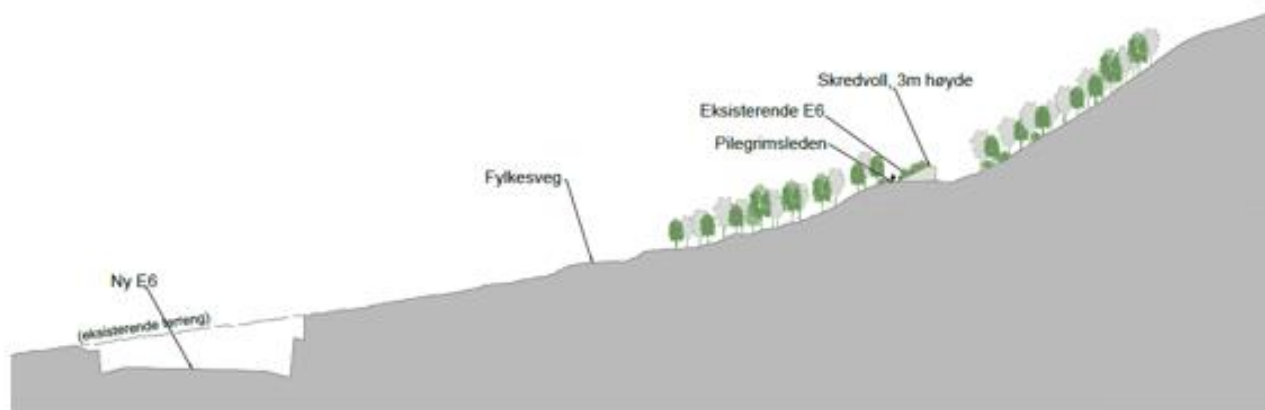
Figur 6-23: Snitt som viser plassering av fangvoll/skredvoll i forhold til ny E6. Skisse: Asplan Viak AS
