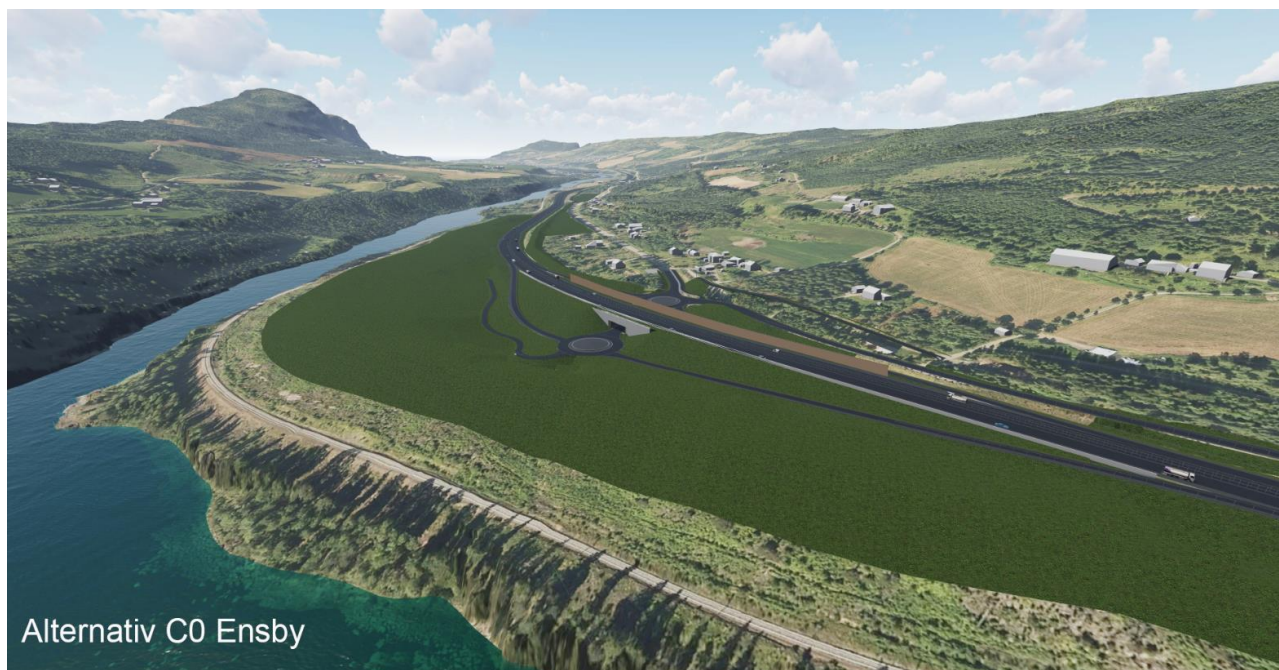
Figur 6-2 Utklipp fra 3D-modell der veiltaket er illustrert oppå flybilde. Dette viser alternativ C0 ved Ensby, sett mot nord. Arealer med grønn eller grå farge blir permanent berørt av nytt veiltak eller som masselager. Illustrasjon: Asplan Viak AS.
