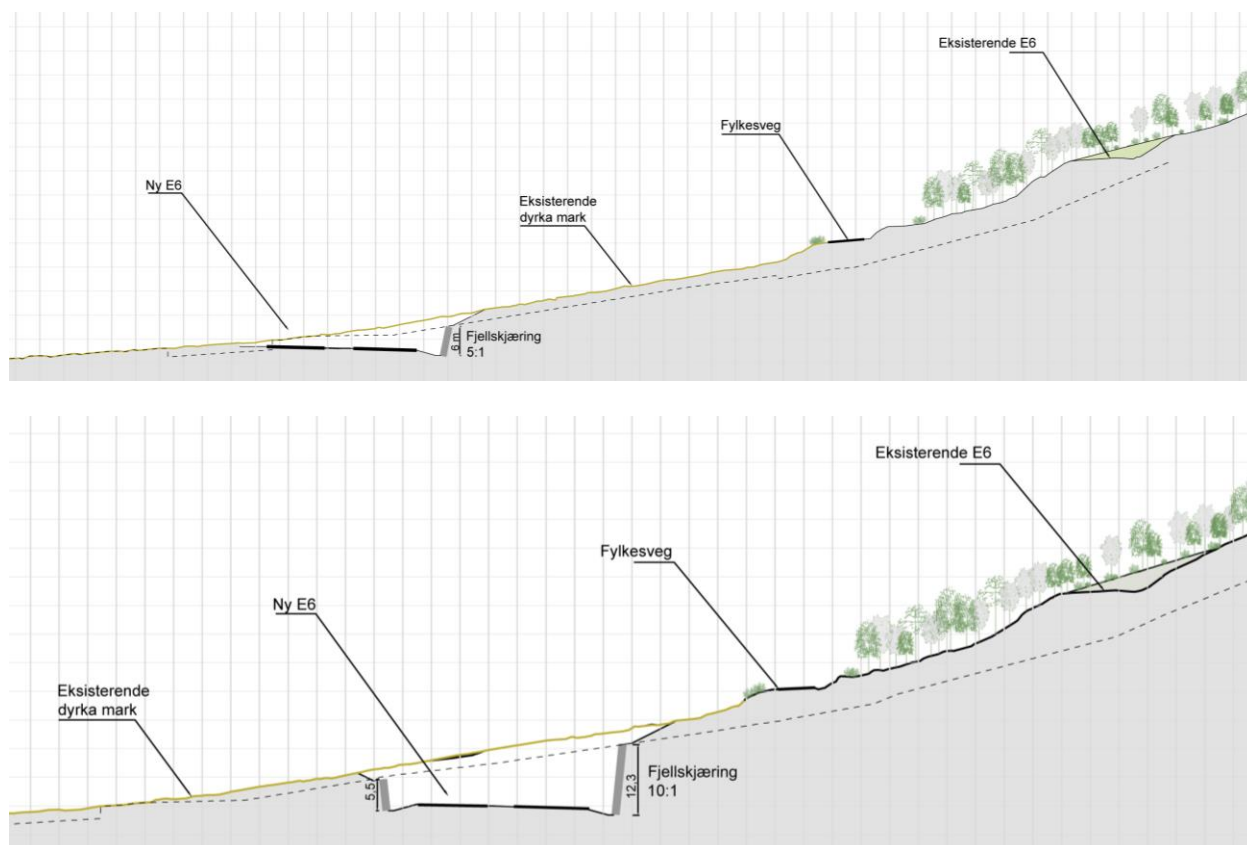
Figur 5-10 Snittene over viser alternativ 1 (øverst) og alternativ 2 (nederst) på samme posisjon midt på Ødegårdsjordet. Alternativ 1 har en skjæringshøyde som variere mellom 6 og 8m. Alternativ 2 har sammenligningsvis en skjæringshøyde på 12-14m. Skisser Asplan Viak AS.
