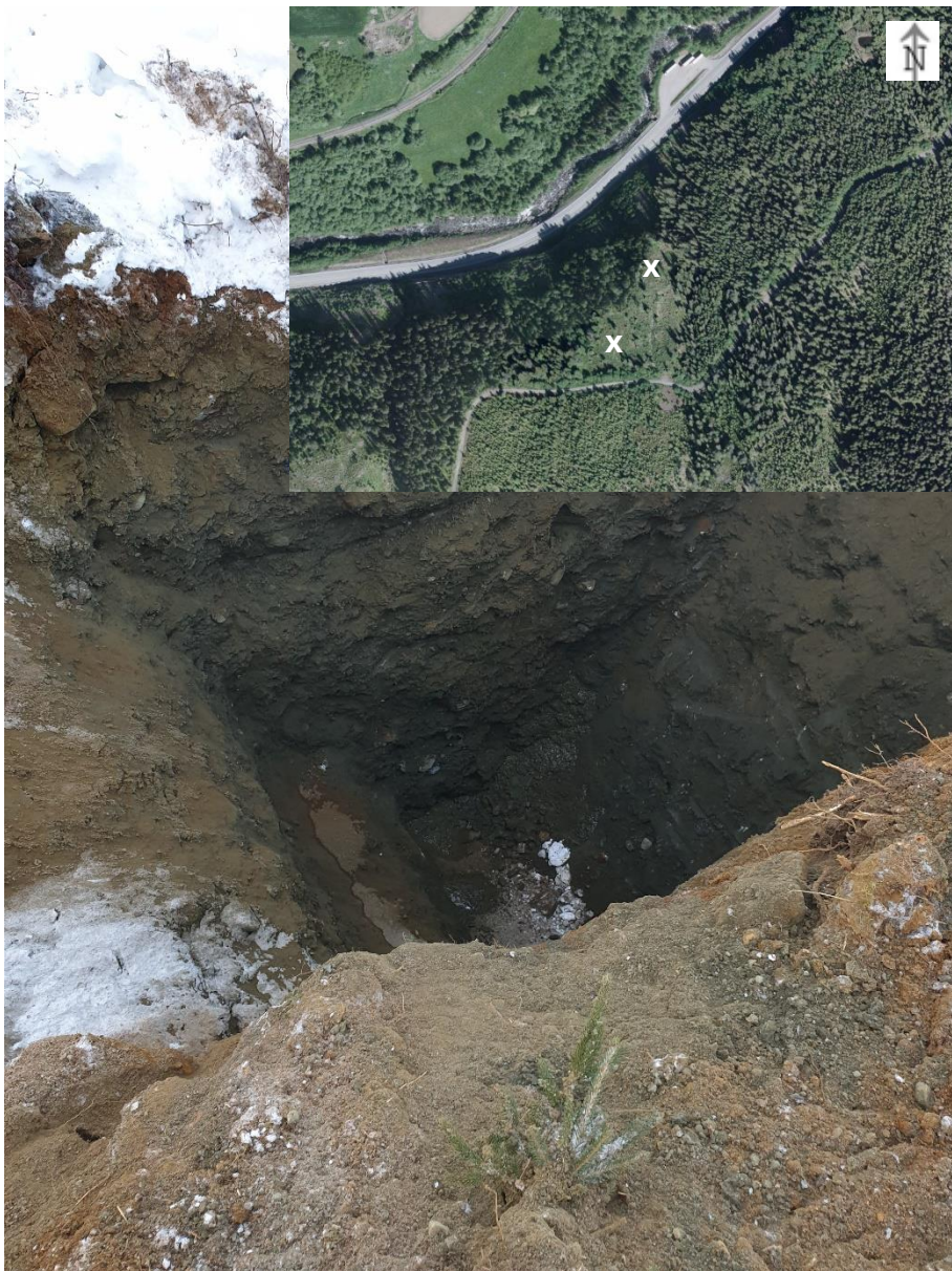
Figur 12 Prøvegravingshull med plassering. Bilde fra prøvehull lengst i nord.
