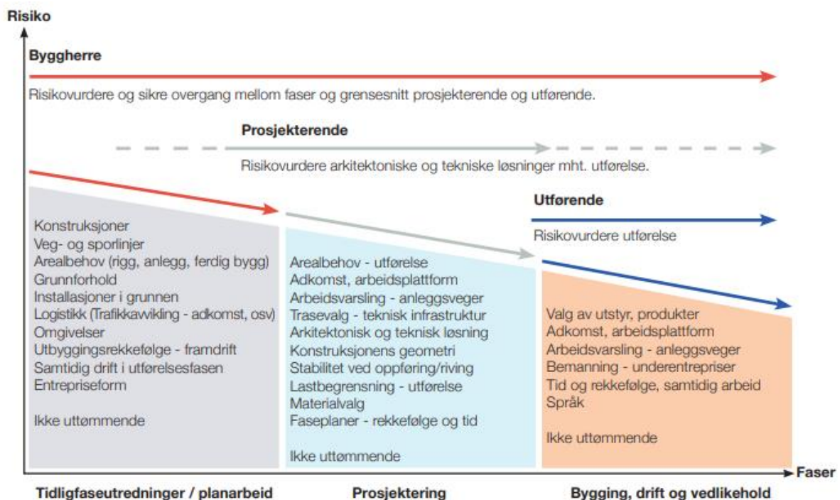
Figur 3-1: Oversiktsfigur som beskriver prosessen med SHA-arbeid i ulike faser i et planarbeid.
