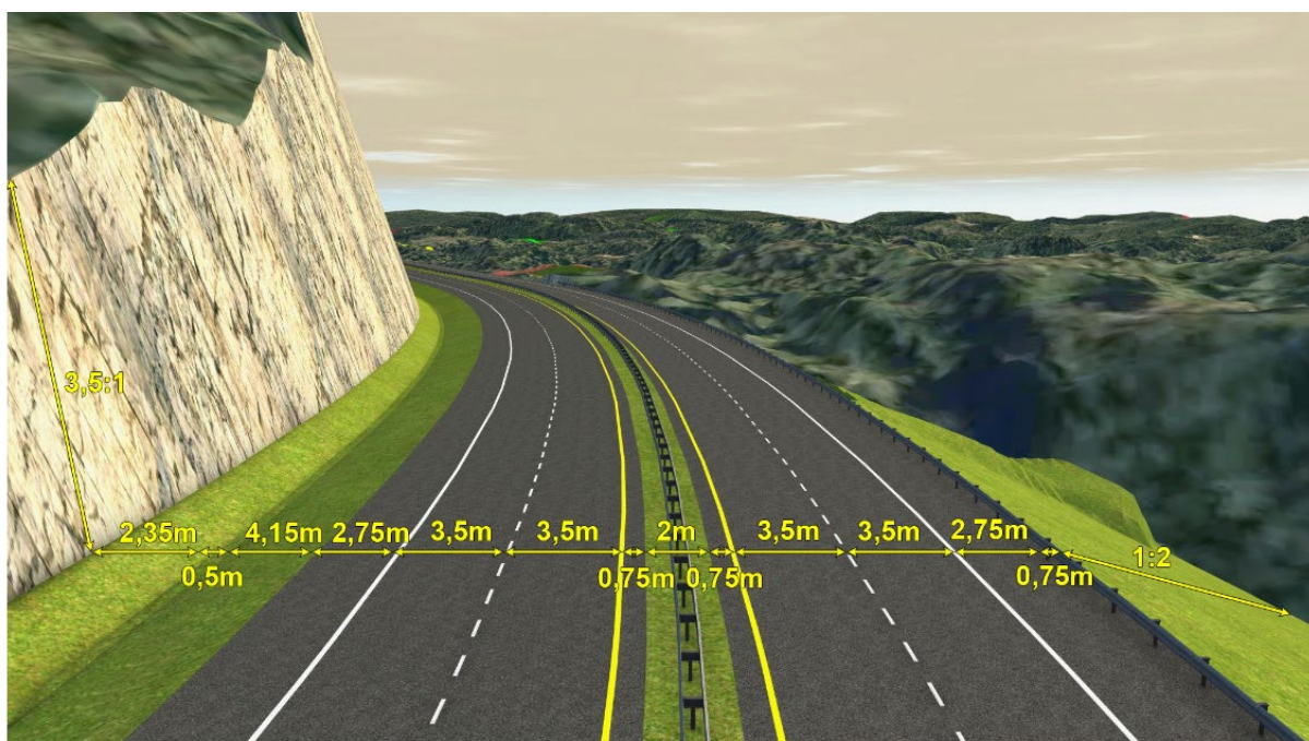
Figur 2-4 Tverrprofil veiklasse H3nv
