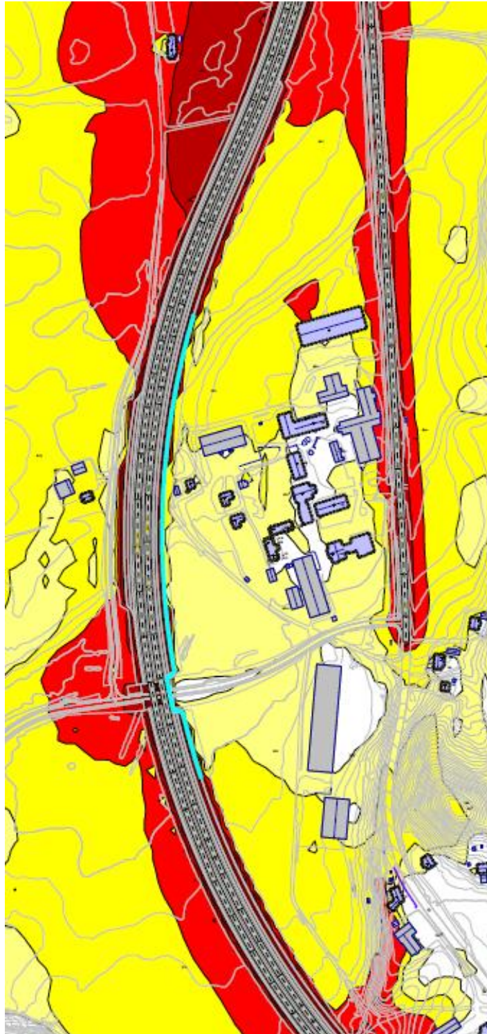
Figur 6 Støykart X008 for Øya. Støynivå L_{den} 1,5 meter over terreng.
