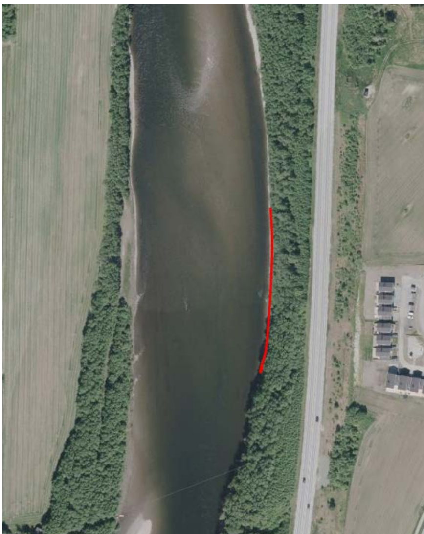
Figur 19: Mulig behov for erosjonssikring.
