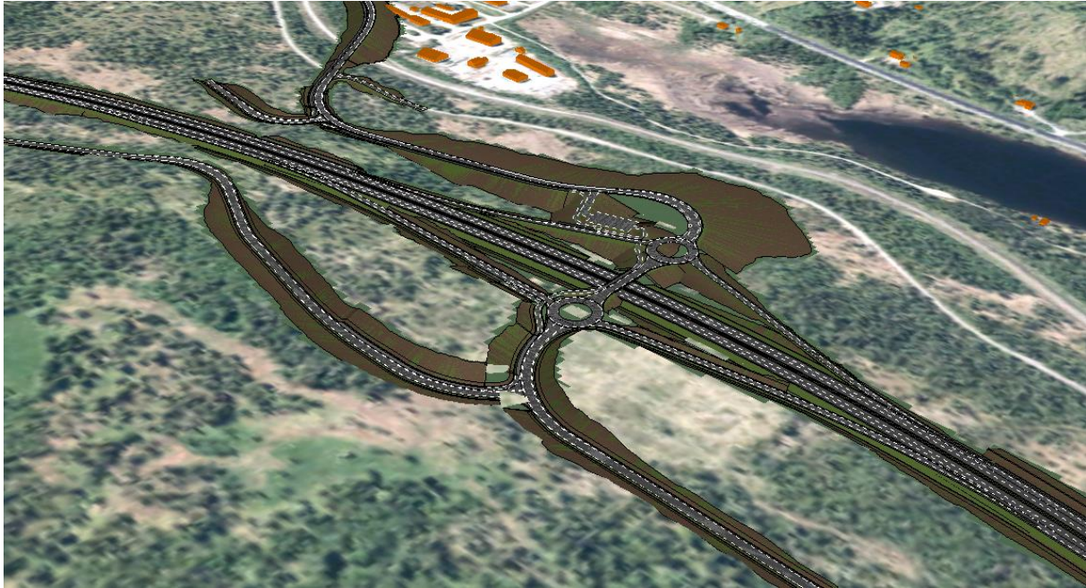
Figur 6-2: Nytt toplanskryss ved Berkåk. (Sweco Norge AS, 22.02.2019).
