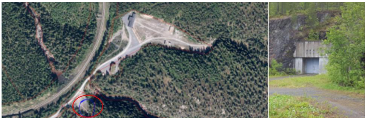
Figur 6-12 Portal for tverrslag til vannkrafttunnel er vist i rødt omriss over. Bilde til høyre viser selve portalbygget.
