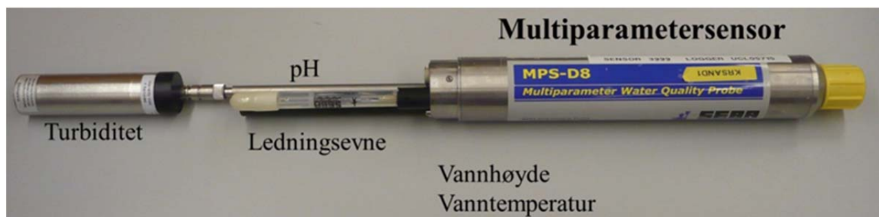
Figur 5. Multiparametersensor for automatisk overvåking av vannkvalitet.
