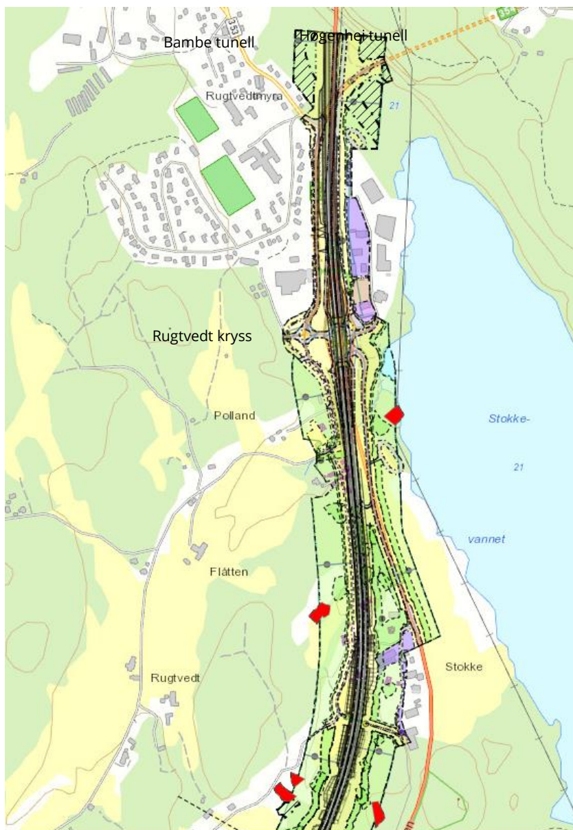
Figur 2-2. Hensynssoner Naturmiljø (skrå skraver) og båndlagte kulturminner (rød markering) på strekningen Rugtvedt - Hegna.
