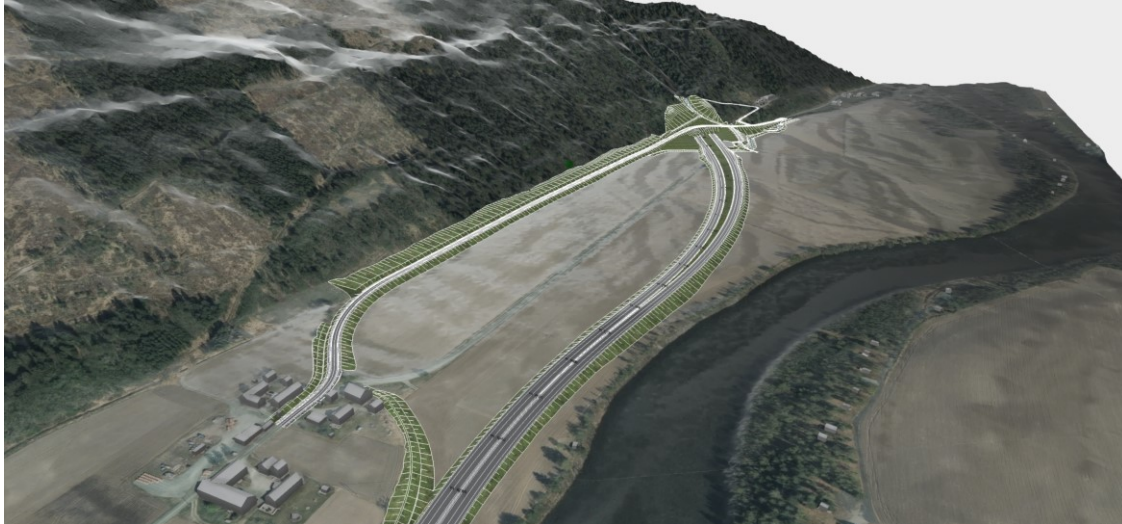
Figur 3-12. Tunnelpåhugget kan etableres med en god vinkel i forhold til fjellets retning. Støyreducerende tiltak vil kunne ivaretas med en kombinasjon av voll og skjerm forbi bebyggelsen.
