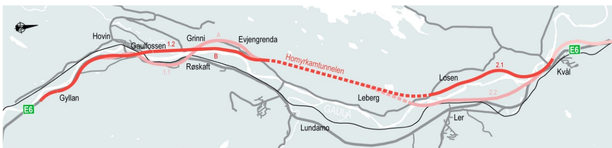
Figur 10-1 Oversikt over alternativer som er utredet, der anbefalingen av veilinje er vist med mørk rød linje. Kilde: Nye Veier.
