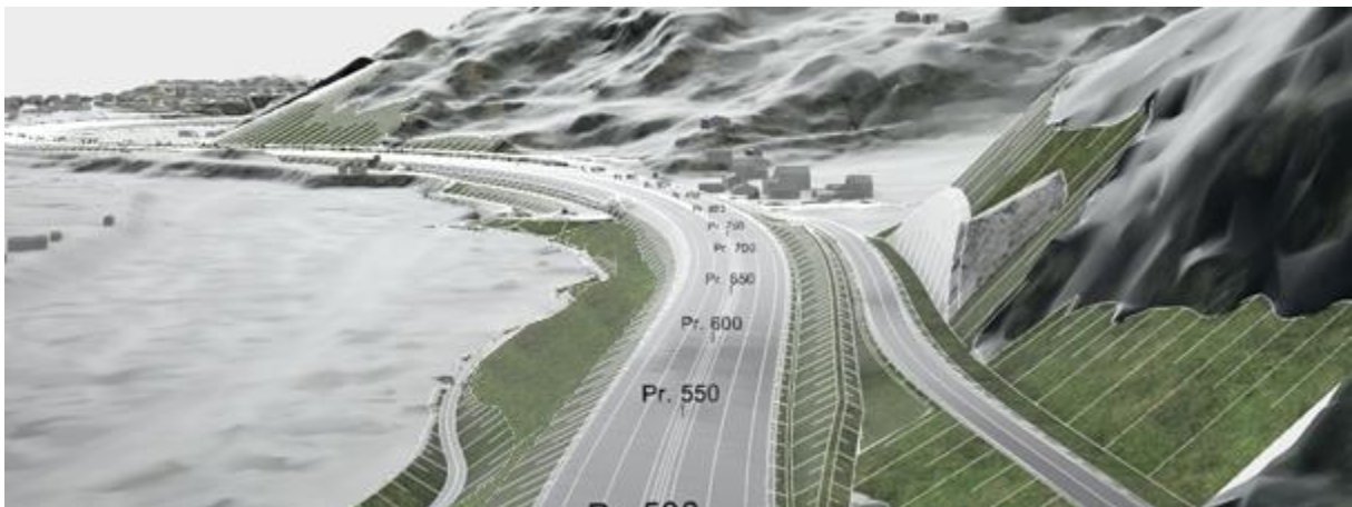
Figur 4-9 Ny E6 har en linjeføring som medfører store jord- og fjellskjæringer i åsryggene sør og nord for Gyllan, samt opparbeidelse av ny elveskråning forbi Gyllan, i samsvar med reguleringsplan fra 2016. (Kilde: Norconsult)
