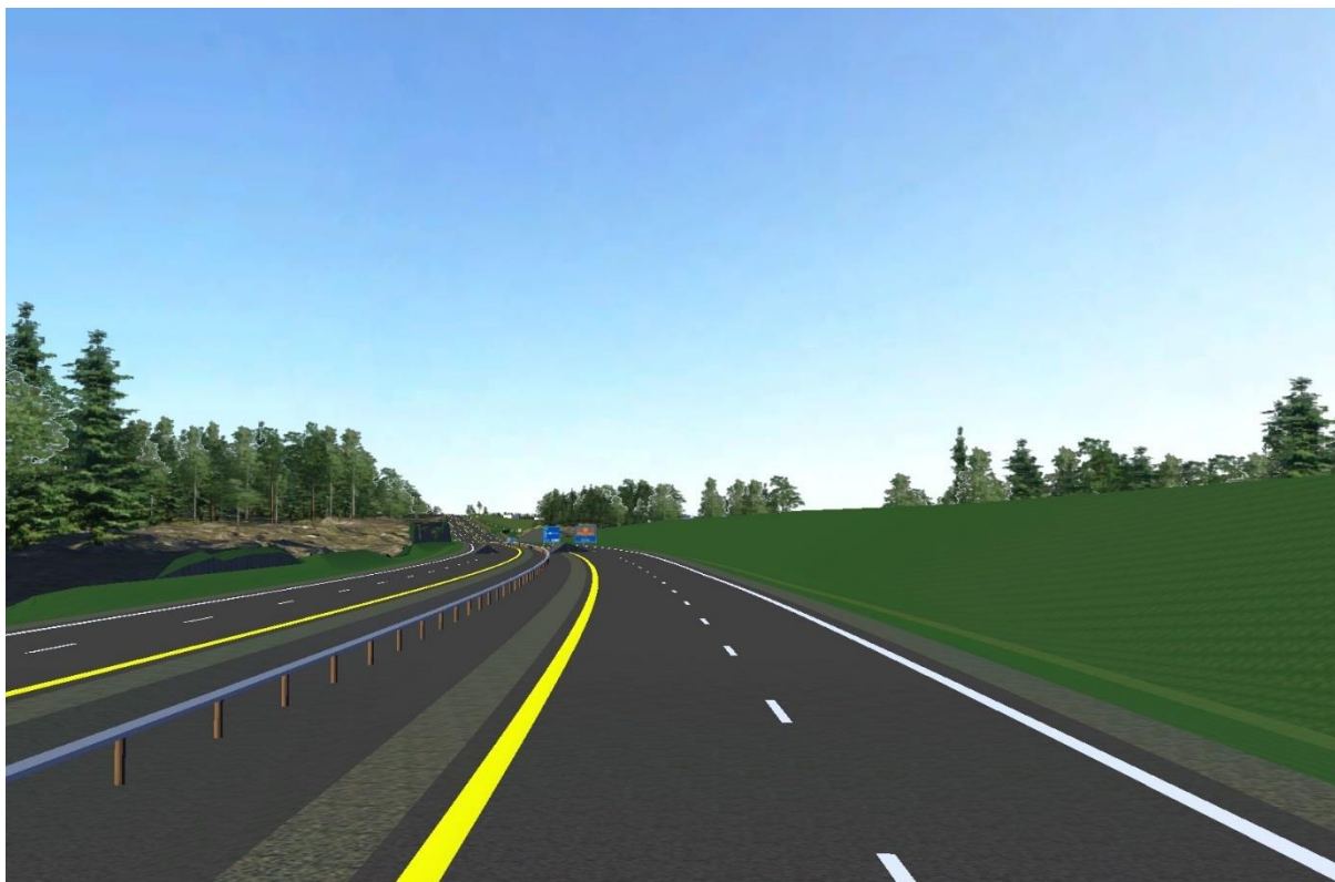
Figur 5-8 Illustrasjon av støyvoll inn mot Sørbygda, utsnitt fra 3D-modell.
