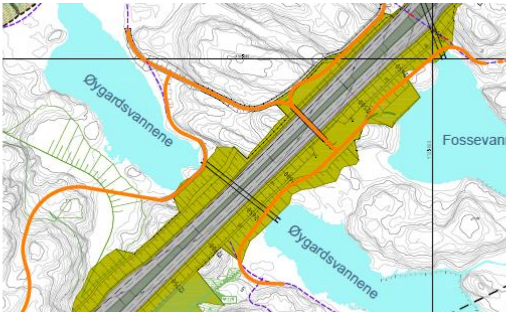
Figur 93: Ved Mjåvann industriområde vil det anlegges erstatningsdriftsveier (oransje linje) inkludert en bru over ny E39. Veiene skal dimensjoneres nøkternt med tanke på turveibruk men gode nok til at de egnest seg for tømmertransport.
