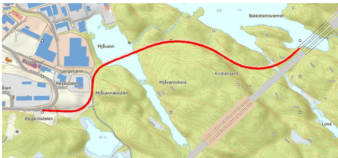
Figur 11: Forslag til avlastningsveg til Mjåvann Industriområde (Rambøll 2016).
