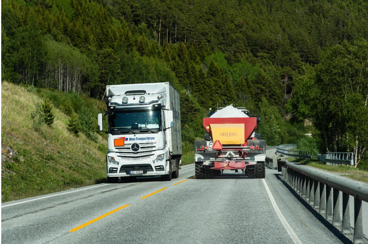
Figur 4-36: Møte mellom bred traktor og semitrailer ved Lesja. Merk at traktoren fyller hele sitt kjørefelt, og traileren har lagt seg ut over kantlinja. Foto: Asplan Viak (CFS) 14. juni 2023
